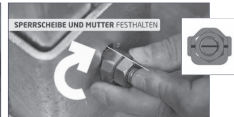
Hammersperrkopf um 90° drehen (Markierungskerbe quer zur Langlochrichtung).
