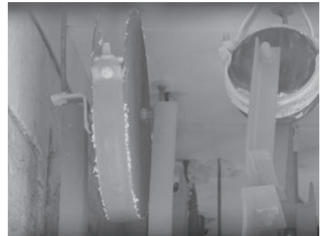
Abb. 4: Systeme nach 90 min. (ca. 1.000 °C)
