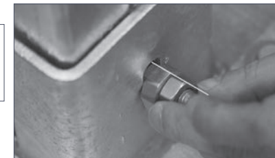
Hammersperrkopf nach vorne zur Führungsnase kippen. Anschliessend durch Eindrehen der Mutter Hammersperrkopf handfest fixieren.
