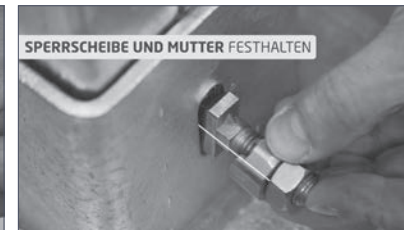
Hammersperrkopf durch das Bauteil und das Profil an gewünschte Position stecken.
