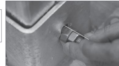
Hammersperrkopf nach vorne zur Führungsnase kippen. Anschließend durch Eindrehen der Mutter Hammersperrkopf handfest fixieren.
