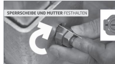
Hammersperrkopf um 90° drehen (Markierungskerbe quer zur Langlochrichtung).
