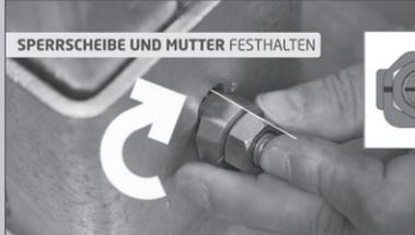
Hammersperrkopf um 90° drehen (Markierungskerbe quer zur Langlochrichtung).
