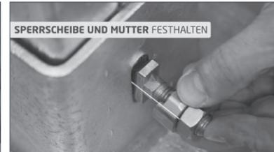
Hammersperrkopf durch das Bauteil und das Profil an gewünschte Position stecken.
