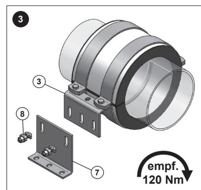
3.) Fussteil (7) mittels Hammersperrkopfschrauben (8) an das Seitenteil (3) anbringen. Gewünschte Höhe einstellen und mit einem Drehmoment von 120 Nm anziehen. Gesamte Konstruktion auf passenden Untergrund (z. B. C-Profil-Schiene, Centum usw.) befestigen.
